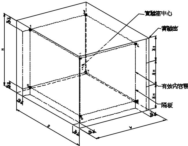
**注意：**1、测试品在摆放过程中要兼顾有效内容积并且要在隔板分隔空间的高度内；如果测试品摆放的太密集会影响箱内气流循环导致温度均匀度达不到国标要求及升降温时间不符合机台性能标称！
