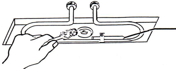
7. 干湿球之湿布经常检查，当测试布表面不干净或变硬，或于做完温度控制后，继续做温湿度控制前都必须更换测试布，或于高温 85℃以上控制后，继续做温湿度控制前。经检查如有不吸水者请更换之，关系到测湿的准确度，测试布一般三月更换一次，更换时应用清洁布擦拭测温体，更换新测试布时应先洗手再把水槽清洗干净
