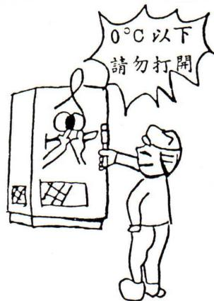
10. 当完成低温运转时或温湿度运转后，务必设定温度条件 60°C 施行干燥处理约半小时，并打开箱门，以免影响下一作业之测定时间或蒸发器结冰现象或测试物损坏。(若未实际 60°C 之干燥处理，机器因而故障，虽于保固期内，亦属人为疏失，恕本公司不予免费服务)
